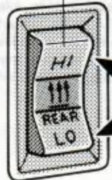
Fan speed control switch
